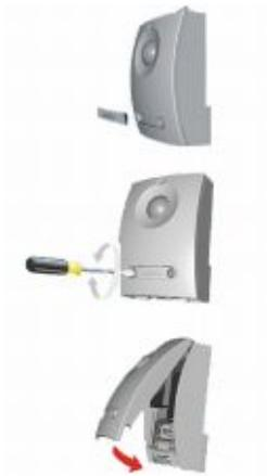
Для того чтобы открыть защитную крышку корпуса сумеречного выключателя необходимо:
